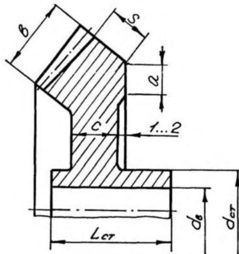
Рис. 2.3.2 Элементы конструкции зубчатого колеса.
