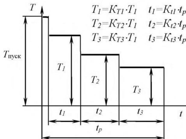
Рис. 3.1.2 Циклограмма нагружения
