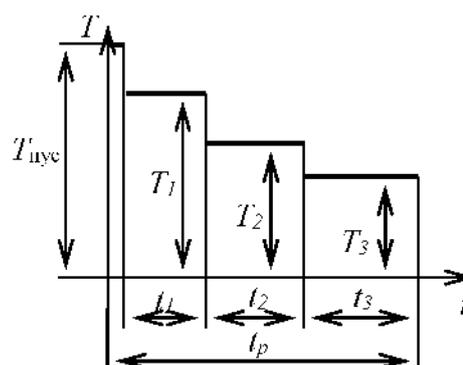
Рис. 9.2 Циклограмма нагружения
