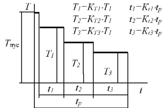
Рис. 1.2 Циклограмма нагружения
