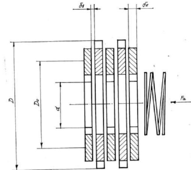
Рис. 15.2.1 Расчетная схема предохранительной фрикционной многодисковой муфты
