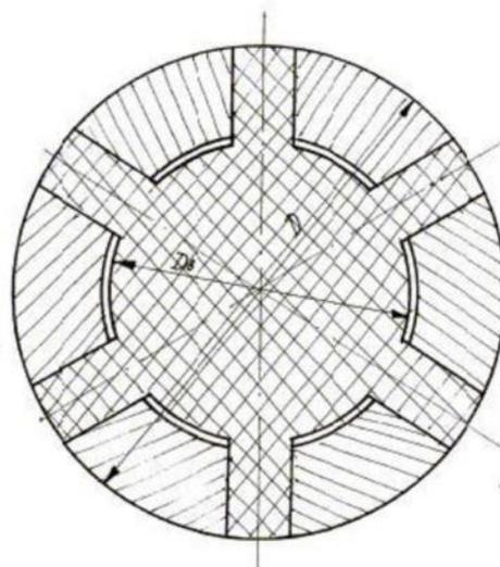
Рис. 15.4.3 Расчетная схема упругой муфты со звездчатым элементом
