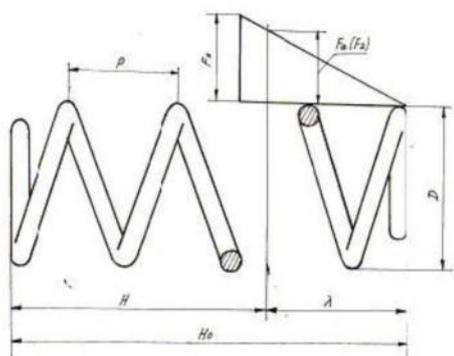
Рис. 15.2.2 Расчетные размеры винтовой пружины сжатия
