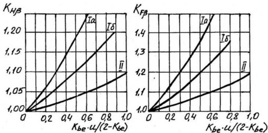
Твердость рабочих поверхностей зубьев  $HВ_1 > 350$  и  $HВ_2 > 350$
