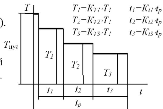
Рис. 2.1.2 Циклограмма нагружения
